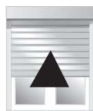
Le moteur monte, il faut changer le sens de rotation
