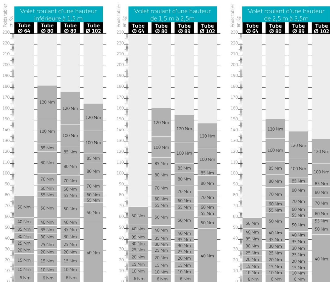
Les couples présentés dans les abaques correspondent au minimum nécessaire au bon fonctionnement du produit porteur.
