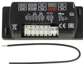
Récepteur radio, autonome 2 canaux pour motorisation de portails et portes de garage.
