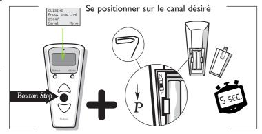
a) Simultanément, maintenir appuyé sur Stop et à l'aide d'un trombone
