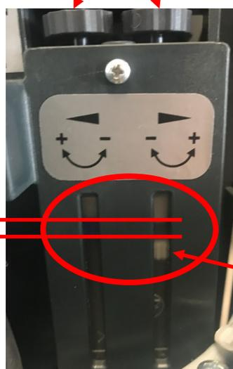
Les deux écrous doivent être positionner à environ **5mm** du haut
