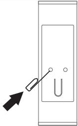
**1** Appuyez sur la touche Prog-TX sur la face arrière de l'émetteur jusqu'à ce que le moteur réagisse
