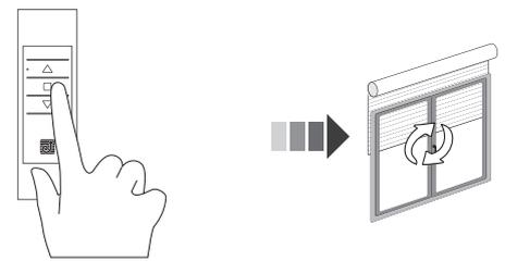
**7** A la pression du bouton stop, le moteur fait un aller-retour. La fin de course basse est maintenant réglée. Vérifiez le bon réglage en faisant un cycle montée - descente complet.
