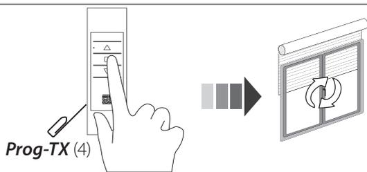
Sur l'émetteur à effacer, presser et maintenir simultanément les boutons Prog-TX et STOP jusqu'à ce que le moteur fasse un aller-retour.
